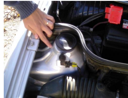
Torreta de amortiguador
